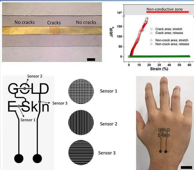
程文龙教授团队采用**金针菇状垂直纳米金线薄膜**和**程序化可控的局部裂纹技术**，制备了一种基于**单一电子材料的多功能电子纹身**。该种多功能电子纹身完全**基于导电垂直纳米金线薄膜**，研究人员通过在纳米金线表面制造纳米裂纹使其从应变不敏感的可拉伸导体转变为应变敏感的应变传感器。这种局部裂纹技术**高度可控、可程序化**。可以对裂纹位置、形状、尺寸、深度以及方向进行精准调控，从而实现应变传感、压力传感、以及应变方向传感等不同功能。这种基于单一材料的多功能电子器件可以**应用于检测人体重要生理特征如体温、汗液葡萄糖和乳酸浓度**，以及**微弱生理信号所引起的形变**，如**脉搏、心率、语音**等等。该工作通过对单一电子材料进行加工与设计实现超薄，多功能的平面内柔性电子纹身，为下一代可穿戴电子器件的设计和发展提供了新的思路。
