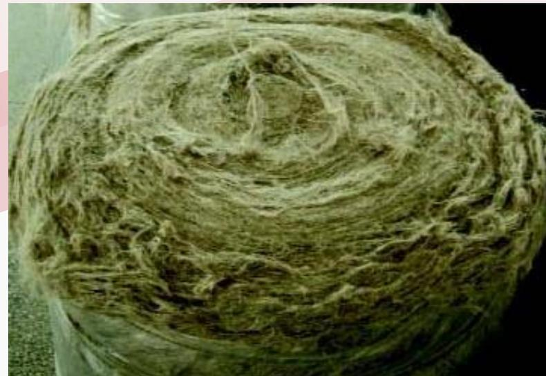
本技术对苧麻纤维进行快速脱胶。通过对苧麻纤维成分的深入测试分析，寻找到有效去除有害成分、保留无害成分的途径，利用新型高效的化学助剂，合理地去除有害成分，不仅大大降低了脱胶的负担，提高了纤维制成率，还可以大大缩短脱胶时间，降低脱胶能耗，使脱胶技术更趋环境友好。
