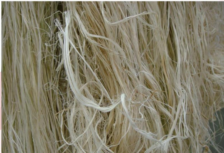
在对纤维长度与纺纱加工和成纱质量深入研究的基础上，成功研发了流程短、产量高的苧麻牵切纺纱方法，该法将苧麻纤维的长度控制在合理有效的范围，并集传统的苧麻纺和棉纺的生产工艺与技术于一体，以较现有苧麻纺纱流程短、生产效率高的纺纱方式生产出更优质的苧麻纱。
