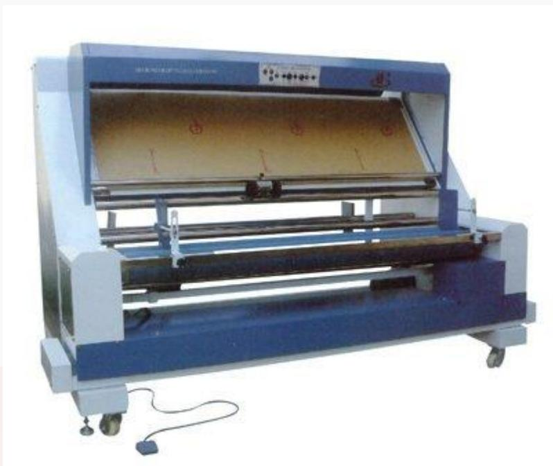
研究开发了基于机器视觉的自动验布系统，解决了机织物坯布长期依靠人工检测的问题。该系统采用CCD获取图像，利用自行研究的10余套算法，结合DSP+FPGA技术实现检测。
