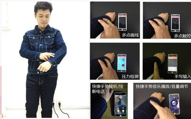
自主研发的触控传感纺织品系列技术，申请十余项中国及国际发明专利，采用现代纺织技术织造而成，既有传统纺织服装的穿着舒适性和可反复洗涤性，又具有高科技含量的无线触控及传感等功能，可广泛应用于触控类智能服装、便携式医疗设备、柔性三位一体（鼠标、键盘及手写）无线输入设备等领域。目前，相关技术已进入中试阶段，有望短期内实现商业化。
