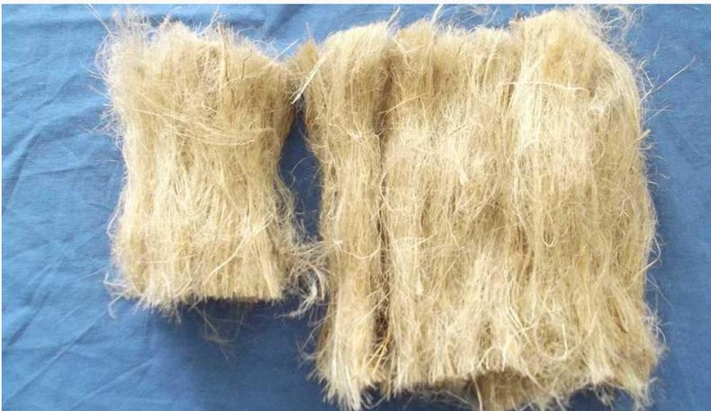
本项目提出了对亚麻、大麻和黄红麻等纤维的精细化加工，即首先对粗硬的亚麻、大麻和黄红麻纤维进行精细的改性处理，再对其在棉纺、苧麻纺和亚麻纺的设备上实现精细化的纺织加工，最后，开发出精细化的麻产品。本项目的特点在于，针对亚麻、大麻和黄红麻纤维的特性和纺纱加工的实际需求，解决了这些麻纤维中木质素的去除与纤维强力保持的矛盾。
