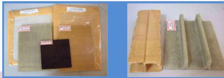
图1 各种三维正交机织高性能纤维织物
